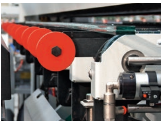
切割+掰片+自动除片, 边料20毫米
