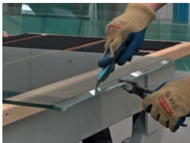
切割+自动掰片+人工除片, 边料20毫米
